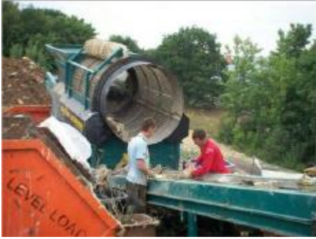
Слика 5.17: Ротациско сито со подвижна лента/линија за рачно сортирање
