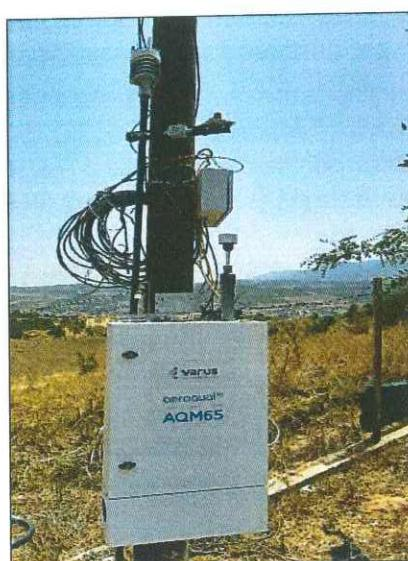
Слика 18: Станица за мерење амбиентен воздух
