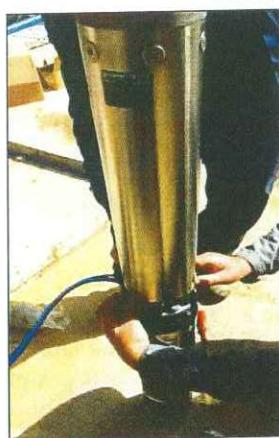
Слика 24: Нова потопна пумпа со мотор 5,5 kw
