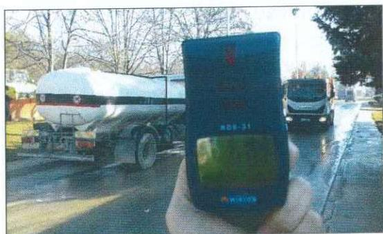
Слика 18: Мерење со апарат за јонизирачко зрачење
