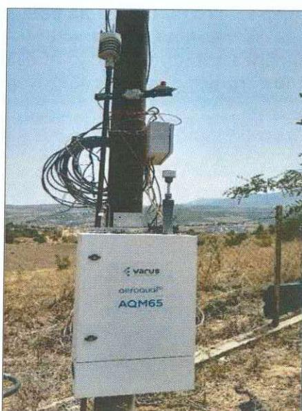
Слика 16: Станица за мерење амбиентен воздух
