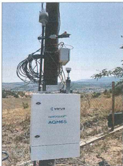
Слика 21: Станица за мерење амбиентен воздух
